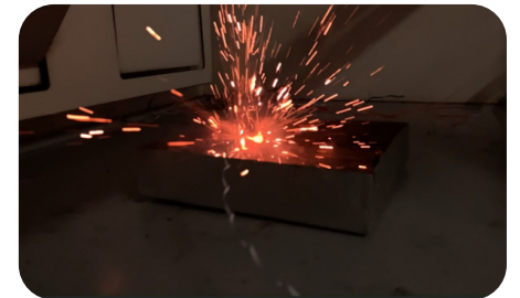
5. ábra: Gyújtókészülék teszt elszívófülkében
